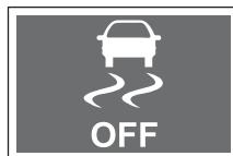
Этот индикатор загорается при нажатии переключателя ESP OFF, отключающем функцию ESP.
