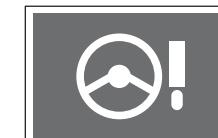
Это предупреждение загорается при повороте ключа зажигания и гаснет после запуска двигателя. Если этот значок загорается во время движения, проверьте систему у дилера Ssangyong или в авторизованном сервисном центре Ssangyong.
