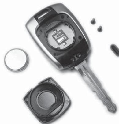
3. Подденьте крышку с помощью небольшой плоской отвертки.
