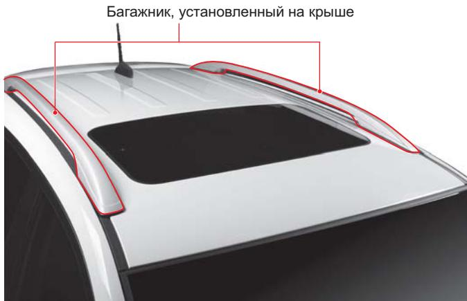
Если автомобиль снабжен багажником на крыше, вы можете загружать вещи на крышу своего автомобиля.
