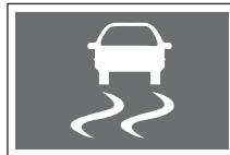
Этот предупреждающий сигнал загорается, когда ключ зажигания находится в положении «ВКЛ», и должен погаснуть, если система исправна.
