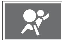
При включении зажигания загорается этот предупредительный сигнал, после чего он должен потухнуть в подтверждение того, что подушка безопасности работает.
