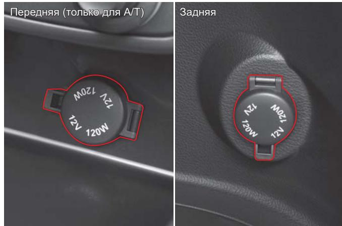
В салоне автомобиля установлена дополнительная розетка для электроприборов. Эта розетка работает, когда ключ зажигания находится в положении «ACC» или «ON».
