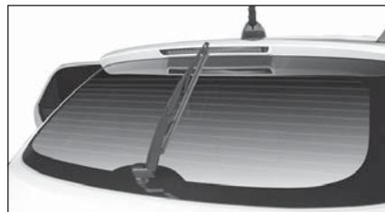
1. Выньте ключ зажигания из замка и подымите рычаг стеклоочистителя из заднего стекла.
