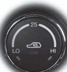
1. Чтобы отрегулировать температуру, поверните этот регулятор.
