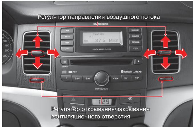
Вы можете отрегулировать направление воздушного потока, перемещая ручку в горизонтальном или вертикальном направлении.
