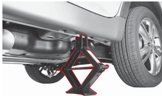
1. Отверните гайки крепления колеса на один или два поворота, повернув их против часовой стрелки с помощью ключа для гаек крепления колеса.
