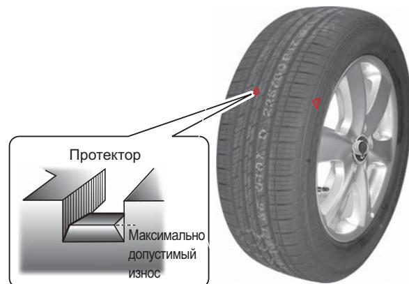
Шины вашего автомобиля оснащены встроенными индикаторами износа, расположенными между канавками протектора. Шины следует менять, когда индикаторы износа появляются на двух или более расположенных рядом канавках.
