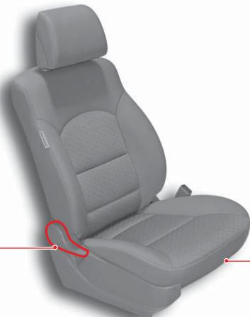
Регулировка наклона спинки
