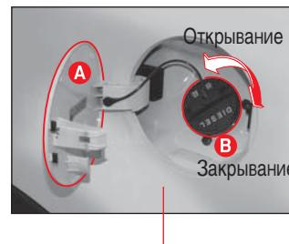
2. Откройте крышку заливной горловины топливного бака (B), повернув ее против часовой стрелки.
