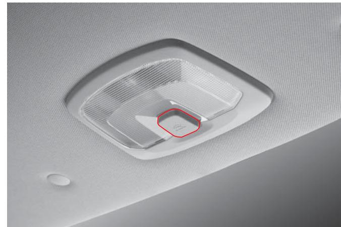
Лампа багажного отделения загорается/гаснет при открывании/закрывании багажника, если этот переключатель установлен в положение совместной работы с дверью багажника).
