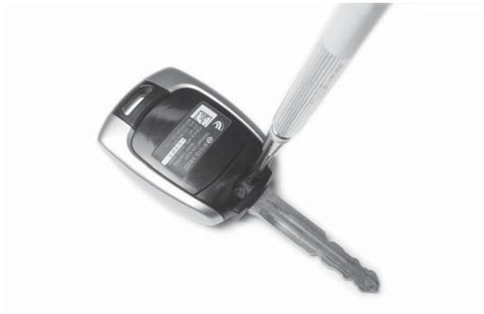
1. Снимите резиновую заглушку с задней части ключа зажигания.
