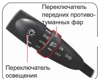
Этот переключатель включает и выключает освещение (фары, задние фонари, габаритные огни, подсветка номерного знака, сигналы поворота, противотуманные фары).
