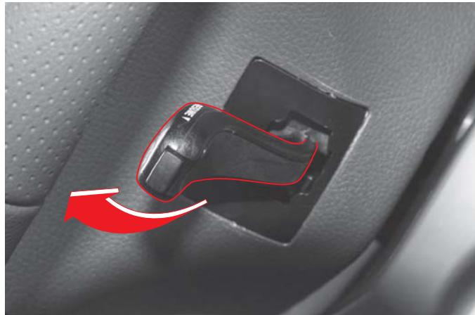
После отключения круиз-контроля можно восстановить предыдущую настройку скорости движения, потянув рычаг круиз-контроля вверх на скорости выше 38 км/ч без нажатия педали акселератора. Но при выключении зажигания внесенная в память настройка скорости стирается, и восстановить ее невозможно.
