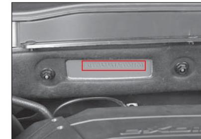
Номер шасси проставляется на теплоизоляционной перегородке со стороны пассажира.
