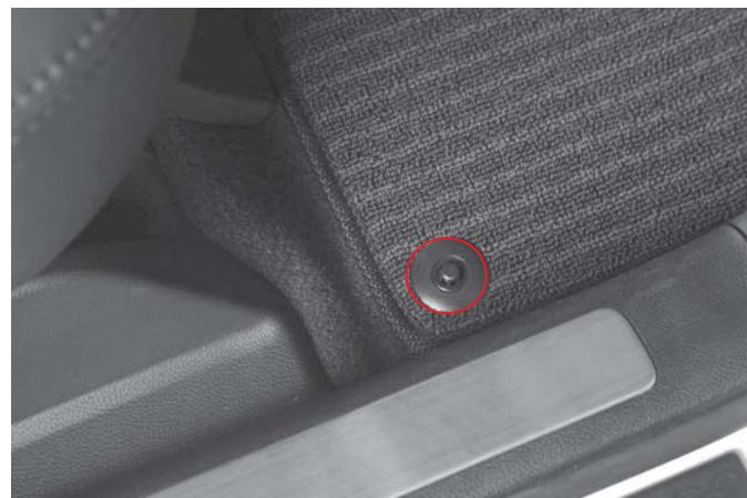
Коврик должен быть зафиксирован с помощью креплений на полу.
