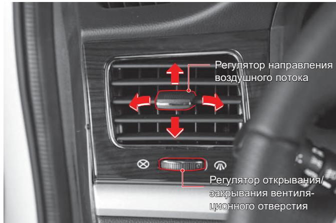
Вы можете отрегулировать направление воздушного потока, перемещая регулятор отверстия для выпуска воздуха. Вентиляционные отверстия можно открыть или закрыть с помощью регулятора.
