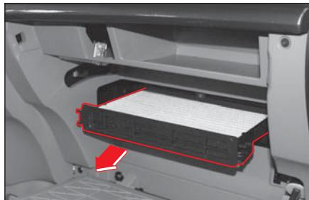
5. Снимите фильтрующий элемент, нажав рычаги с обеих сторон.
