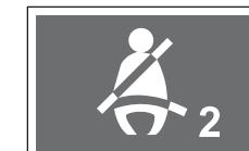
Если не будет надежно закреплен ремень безопасности на пассажире, занимающем переднее сидение, то после поворота ключа зажигания в положение «ON» (ВКЛ) в течение 6 секунд будет мигать предупредительная сигнальная лампочка и звучать предупредительный зуммер. Действие этого напоминания прекращается, когда пассажир пристегивает ремень безопасности, даже если сигнал еще включен.
