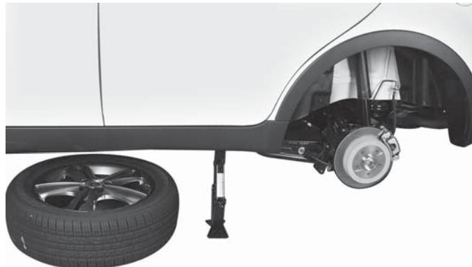
5. Снимите колесо и поместите его под кузов автомобиля. Это позволит максимально снизить опасность при соскальзывании домкрата.
