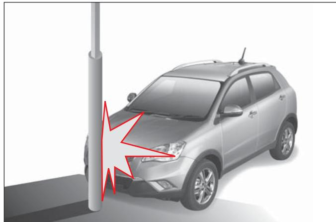
Подушки безопасности могут не раскрыться, если автомобиль сталкивается с такими объектами, как столбы коммунальных служб или деревья, когда точка удара сконцентрирована в одном месте, и датчикам не сообщается полная сила воздействия.
