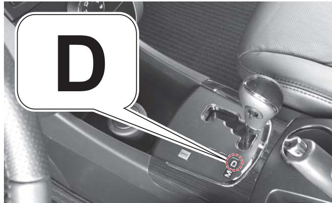
Используйте это положение в общих условиях движения. Коробка передач автоматически переключает передачи с 1-ой по 6-ую в зависимости от уровня нажатия педали акселератора и скорости автомобиля.
