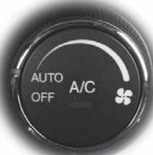
1. Чтобы отрегулировать скорость вентилятора, поверните этот регулятор.
