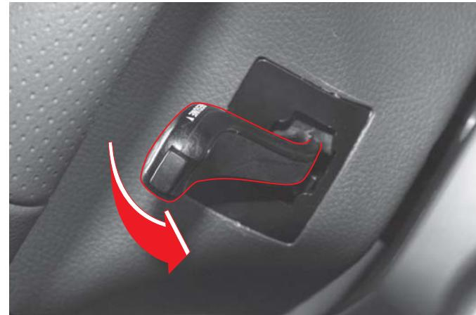
После отключения круиз-контроля можно восстановить предыдущую настройку скорости движения нажатием рычага круиз-контроля на скорости выше 38 км/ч без нажатия педали акселератора. При этом плавное ускорение до установленной скорости движения достигается благодаря оптимизации расхода топлива.
