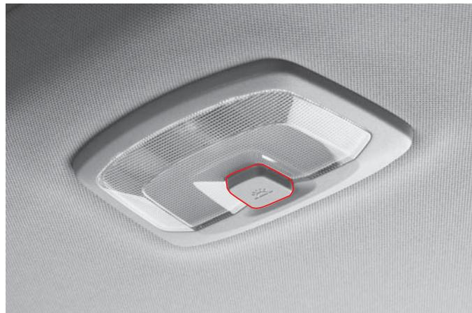
При нажатии этого переключателя включается лампа в центре салона. Повторное нажатие отключает ее. Однако, если переключатель основного освещения салона в положении одновременной работы с дверями, эта лампа включается/выключается при открывании/закрывании дверей.
