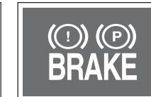
Если предупреждающий сигнал ABS и предупреждающий световой сигнал тормоза горят одновременно, то система EBD (электронного распределения тормозных усилий) неисправна. В этом случае антиблокировочная тормозная система (ABS) также не включается.
