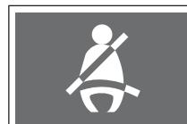
Если на водителе не будет надежно закреплен ремень безопасности, то после поворота ключа зажигания в положение «ON» (ВКЛ) в течение 6 секунд будет мигать предупредительная сигнальная лампочка и звучать предупредительный зуммер. Действие этого напоминания прекращается, когда водитель пристегивает ремень безопасности, даже если сигнал еще включен.
