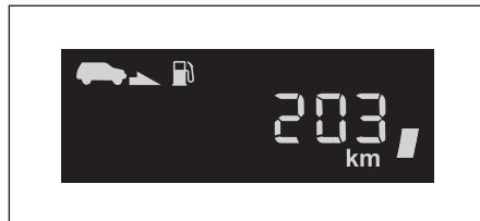
ЖК-дисплей показывает, как далеко вы сможете проехать с текущим количеством топлива в топливном баке.
