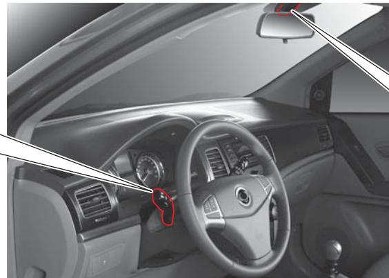
Автоматический датчик освещения и дождя\*
