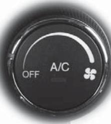
1. Чтобы отрегулировать скорость вентилятора, поверните этот регулятор.
