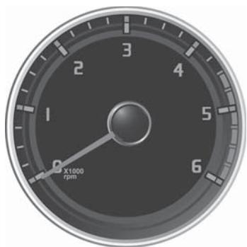
Тахометр показывает частоту вращения двигателя в оборотах в минуту. Умножьте 1000 на указанное число и получите текущее число оборотов двигателя.
