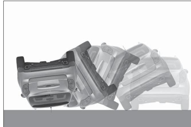
Подушки безопасности могут не сработать при аварии с опрокидыванием, поскольку раскрытие подушек безопасности не обеспечит надлежащей защиты водителя и пассажиров.
