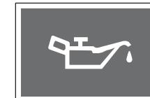
Это предупреждение загорается при повороте ключа зажигания и гаснет после запуска двигателя.
