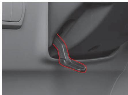
Установите рулевое колесо под нужным углом (по высоте: для электро- и гидроусилителей) и в нужное положение (по длине: только для электроусилителей), потянув рычаг разблокировки вниз, а затем зафиксируйте положение рулевого колеса, потянув рычаг разблокировки вверх.
