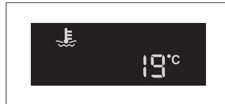
ЖК-дисплей показывает температуру окружающего воздуха (только для авто-кондиционеров)
