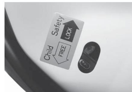
Блокировка замка дверей от детей предотвращает случайное открывание дверей, особенно когда дети находятся в автомобиле. Когда рычажок детской блокировки находится в положении «LOCK», задние двери можно открыть только снаружи.
