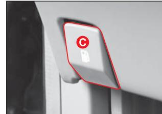
1. Откройте дверцу заливной горловины топливного бака (C), потянув за рычаг, расположенный на нижней части рулевого колеса, слева.
