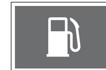
Это предупреждение загорается при повороте ключа зажигания и гаснет после запуска двигателя.
