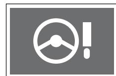
Эта сигнальная лампа загорается при включении зажигания и гаснет после запуска двигателя.
