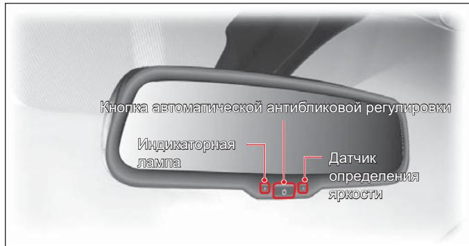
Степень отражения внутреннего зеркала заднего вида может быть автоматически отрегулировано в зависимости от интенсивности света фар авто, движущегося сзади нажатием кнопки автоматической антибликовой регулировки. При нажатии кнопки появляются соответствующие индикаторы. Повторное нажатие приводит к отключению индикаторов и деактивации функции.
