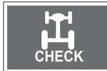
Этот предупредительный сигнал загорается, когда ключ зажигания находится в положении «ВКЛ», и должен погаснуть, если система исправна.
