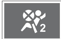
Этот индикатор загорается при повороте переключателя отключения подушки безопасности пассажира в положение «ВКЛ», отключающего подушку безопасности пассажира. Подробнее об этом читайте в главе 8.
