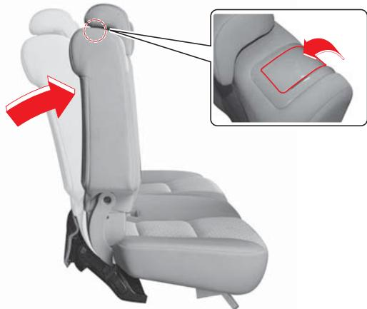
1. Потяните рычаг регулировки спинки заднего сиденья вверх и установите ее в вертикальное положение.
