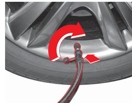
7. Открутите пыльник колеса и вкрутите клапанное соединение воздушного шланга до края резьбы воздушного клапана шины.
