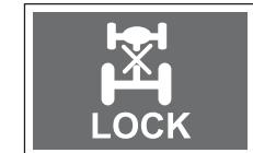
Этот предупредительный сигнал загорается, когда ключ зажигания находится в положении «ВКЛ», и должен погаснуть, если система исправна.
