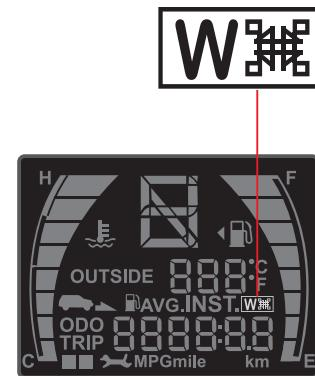
Индикатор загорается при нажатии переключателя зимнего режима (W) возле рычага переключения передач.
