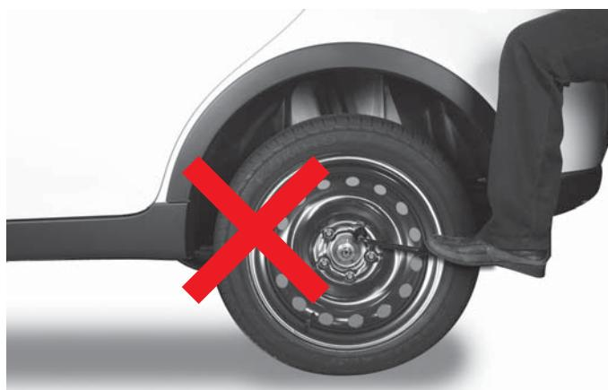
При чрезмерном затягивании возможно повреждение гаек. Не перетягивайте гайки крепления колеса, нажимая на ключ ногой или используя вспомогательные рычаги.
