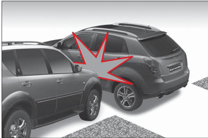
Передние подушки безопасности могут не раскрыться при боковом столкновении, потому что пассажиры двигаются в сторону столкновения, и, следовательно, раскрытие передних подушек безопасности не обеспечит должной защиты.
