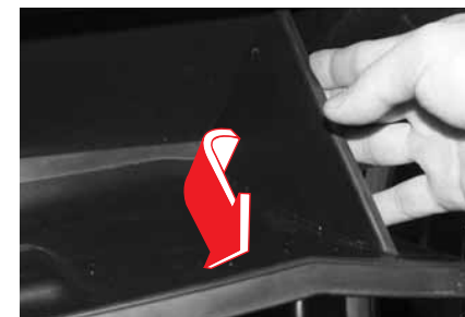
3. Опустите правую сторону отделения для перчаток в направлении стрелки.
