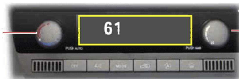
1) Слегка поверните ручку регулировки скорости вентилятора для запуска 6 этапа самодиагностики
